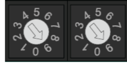
Exemple : interrupteurs rotatifs indiquant le n° d'identifiant 99.
