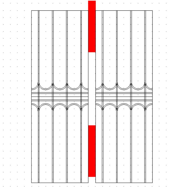
Pour un passage de portes, il suffit d'utiliser 4 plaques tête bêche
