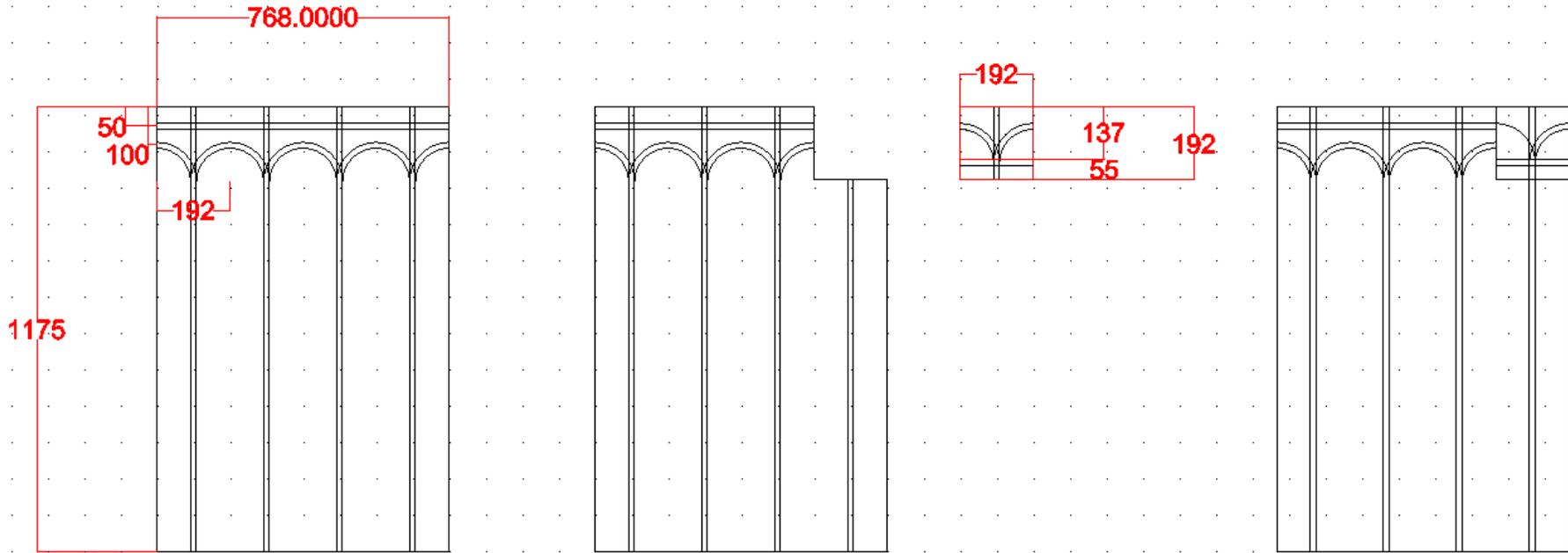
Pour un retour de boucle, il suffit juste de découper un carré de 192 x 192 mm et de la recouper en 2 morceaux de 137 et 56 mm pour permettre de remonter le retours.
