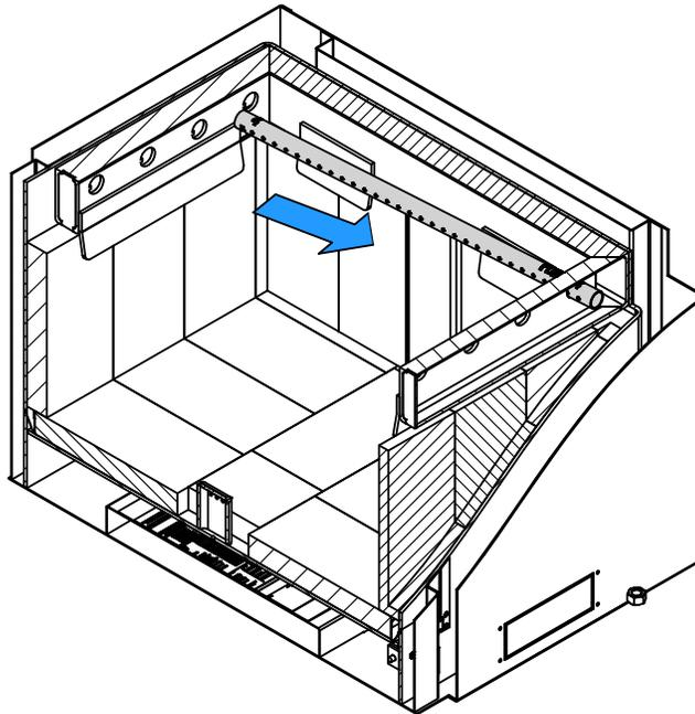
2. Aligner le chemin du tube et la dent dans le trou de la canalisation. Tenir le tube à l'aide d'une pince de serrage et suivre le mouvement décrit dans la figure au-dessous pour le sécuriser en place. S'assurer que la dent touche le fond du chemin du tube.
