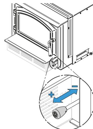
Si les flammes diminuent au point de disparaître, c'est que l'air a été réduit trop tôt dans le cycle de combustion ou que le bois utilisé est trop humide. Si le bois est sec et que le contrôle d'air est utilisé correctement, les flammes devraient diminuer, mais rester vives et stables.
