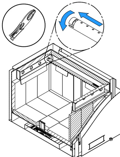
Prendre note que n'importe quel tube (A) peut être remplacé sans retirer le coupe-feu (B) et que tous les tubes sont identiques.
