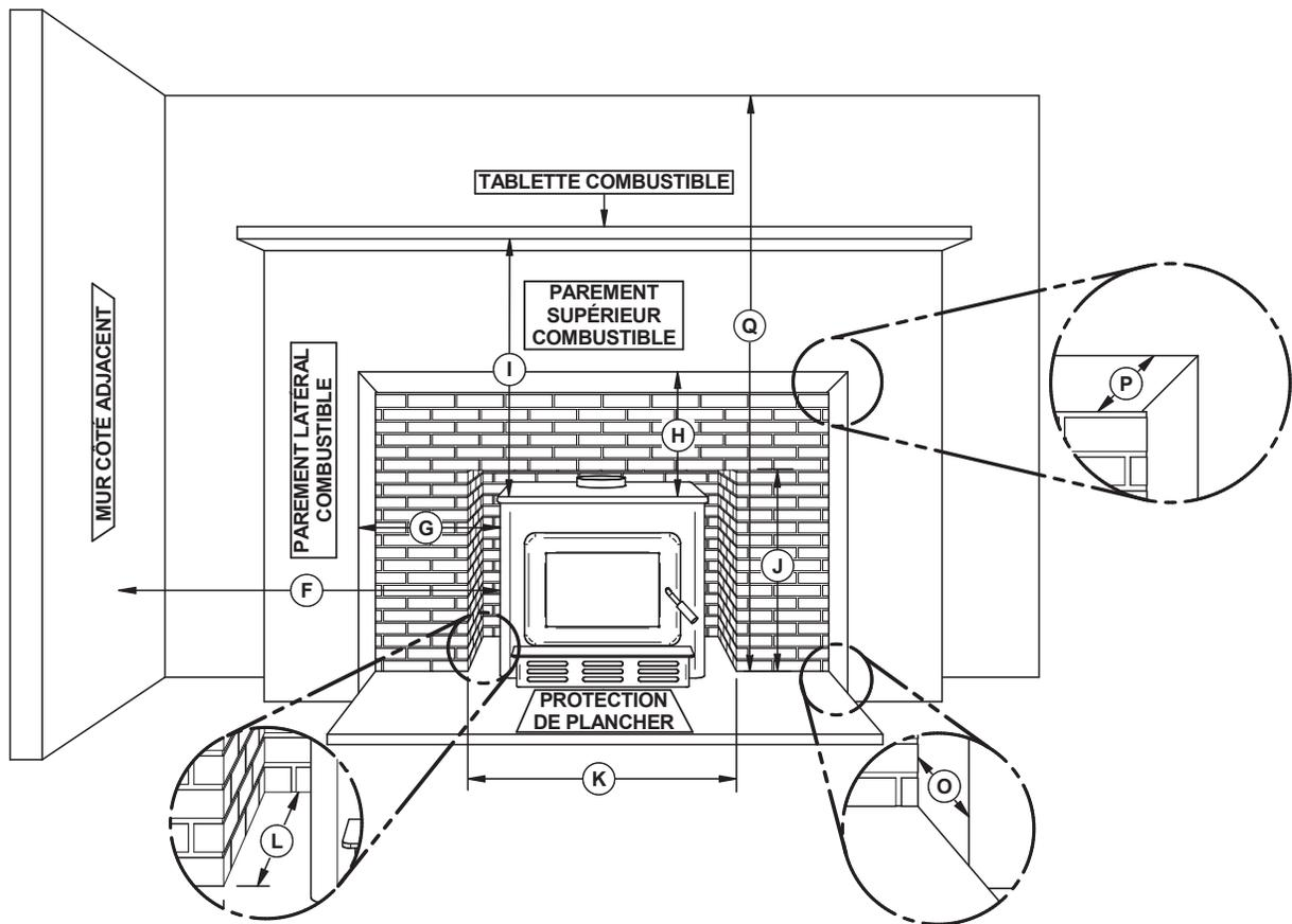
Figure 15: Ouverture de l'âtre et dégagements aux combustibles
