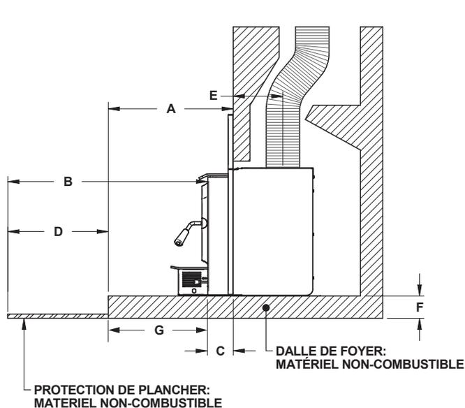
Figure 13: Protection de plancher aditionnelle - Installation surélevée
