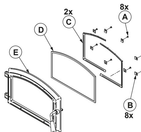
*Les deux principales causes de bris de vitre sont un placement inégal de la vitre dans la porte et un serrage excessif des vis.*
