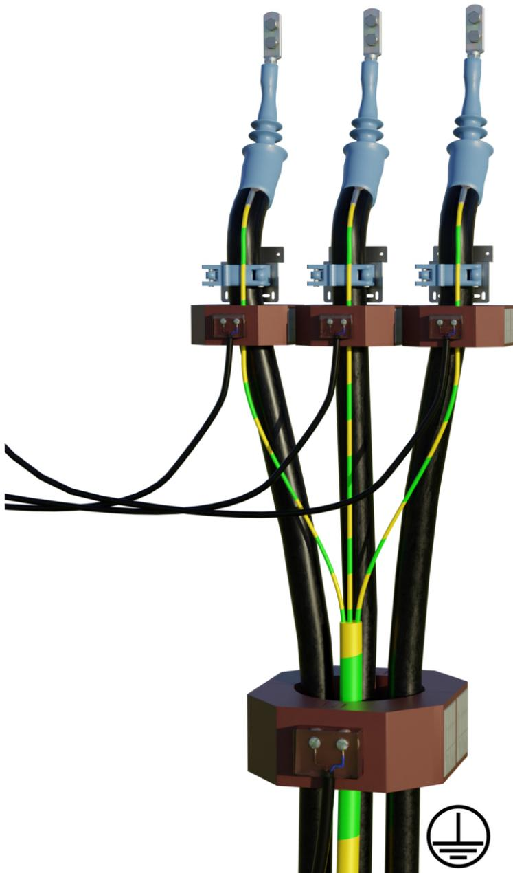
Abbildung 4: Fachgerechte Erdung bei Kombination von Leiter- und Summenstrommessung
