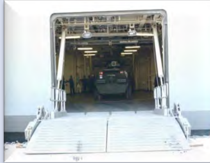
Side Ramp အား အမှတ်(၃)ရေတပ်ဆိပ်ခံတံ တားတွင် စမ်းသပ်ချနေပုံ
