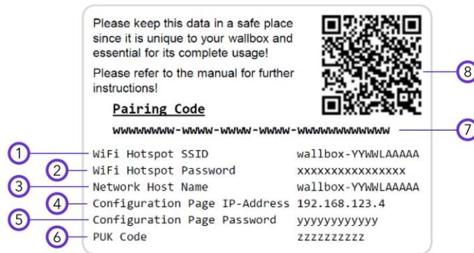
Abbildung 1: Exemplarische Darstellung des Konfigurationsaufklebers für den Elli Charger Connect und Elli Charger Pro
