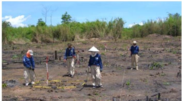
Grâce à un détecteur «Large Loop» de Ebinger, les techniciennes FSD localisent des engins explosifs jusqu'à 8 mètres de profondeur
