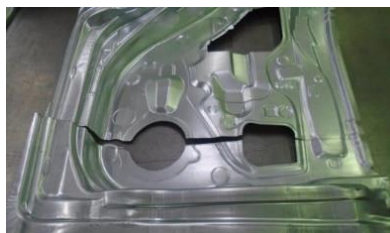
Figura 1. Partes estructurales del coche rotas tras el estampado a causa de defectos en el cordón
