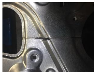
Figura 1. Partes estructurales del coche rotas tras el estampado a causa de defectos en el cordón
