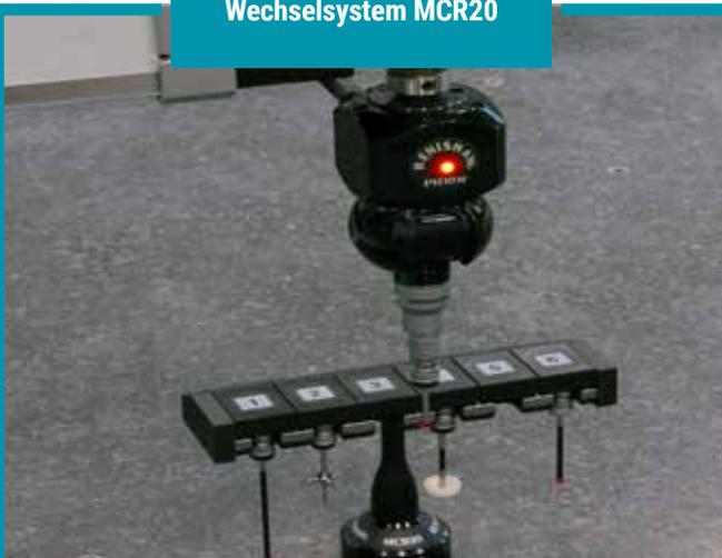
Flexibles Wechselsystem für einen automatischen Wechsel der SP25M Scanning- und Tastermodule mit 3 Stationen (6, 9, 12 und 15 Stationen möglich).
