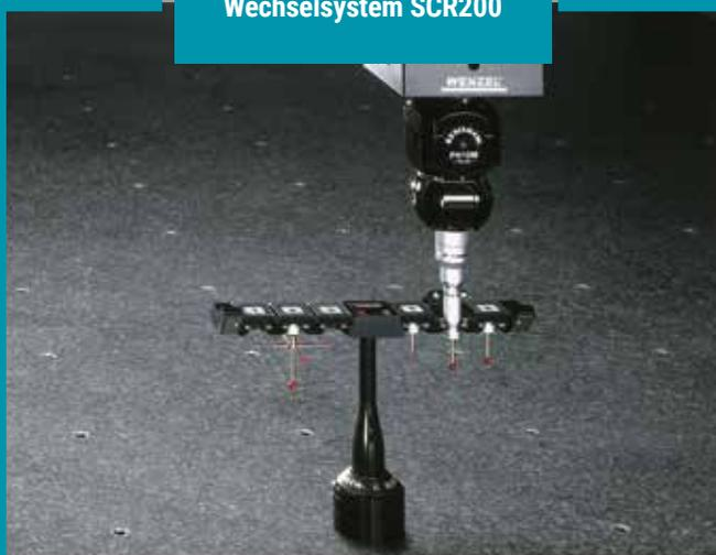
Mit dem SCR200 Wechseltmagazin können bis zu sechs TP200 Tastereinsatzmodule schnell und automatisch gewechselt werden. Das SCR200 wird von einem separaten Interface (PI 200) gesteuert und verfügt über einen Kollisionsschutz gegen mechanische Beschädigung.
