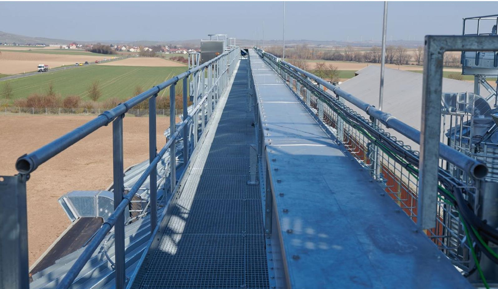
Vollflächige Laufsteganlage mit Trogkettenförderer; Länge: rund 60 m
