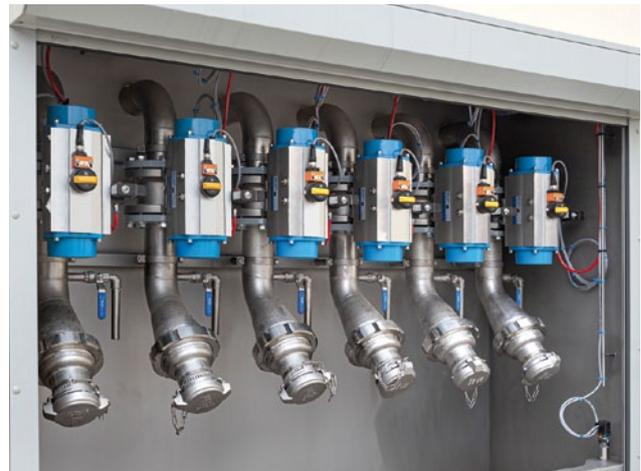
Flüssigkeitseinlassstation von IVS mit Radarerkennung
