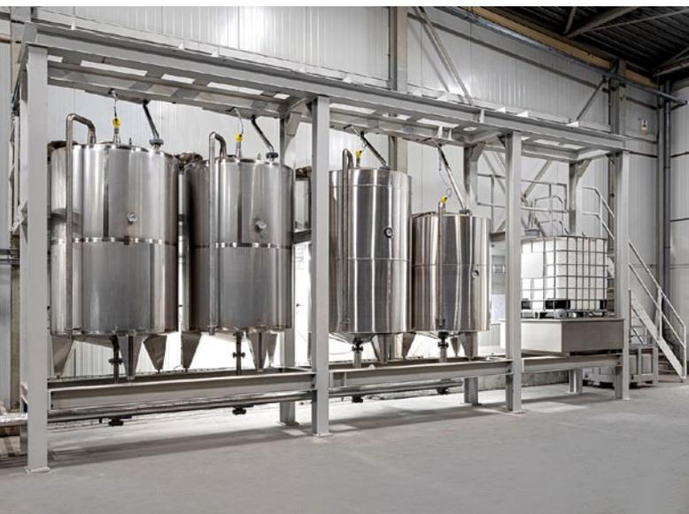
Stahlkonstruktion für mehrere IBC-Container
