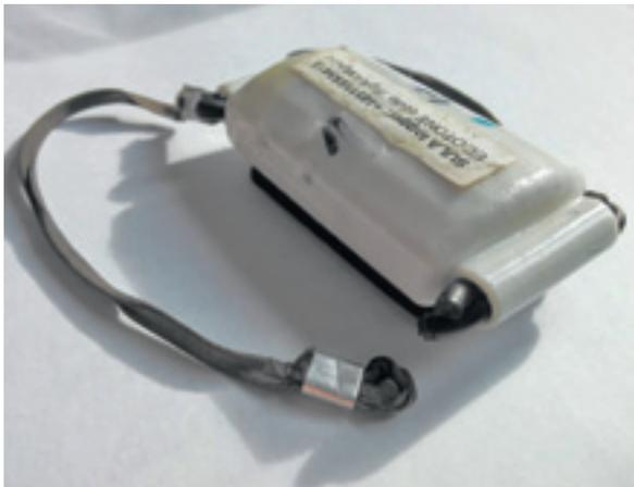
Abbildung 3: Der ideale Habichtskauz-Telemetrie-sender: das Sendermodell „URAL“, ein speziell für den Habichtskauz entwickelter GPS-GSM-Sender mit Batteriebetrieb, harter Schale und interner Antenne. Sollbruchstelle ist ein Perbunan-Dichtungsring – in der Abbildung: eine planmäßig gebrochene Sollbruchstelle. (Foto: Christoph Leditznig).
