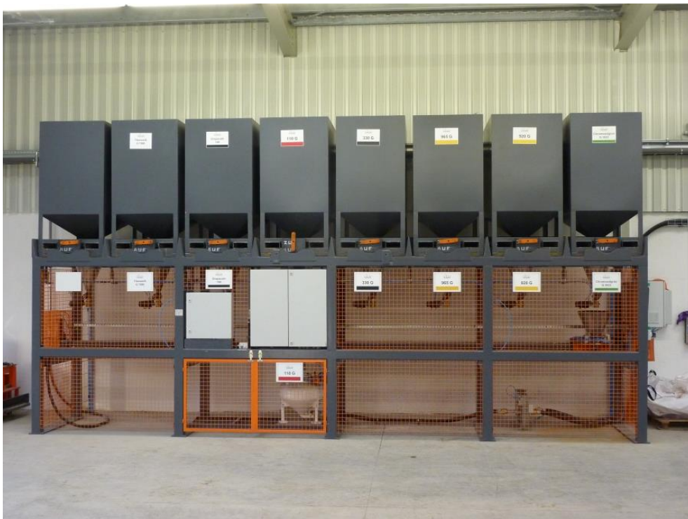
Granulatdosieranlage Grapados für 8 Farben
