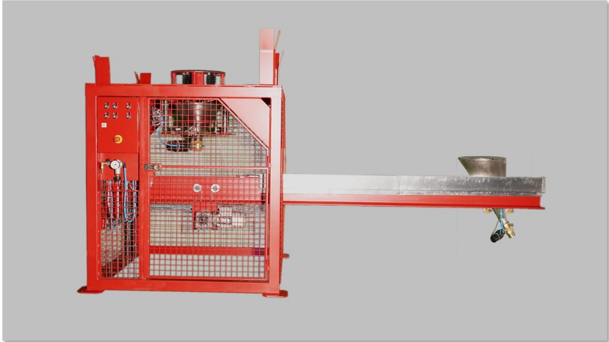
Dosiersystem Exaccos zur Kleinmengendosierung von Pigmentgranulaten
